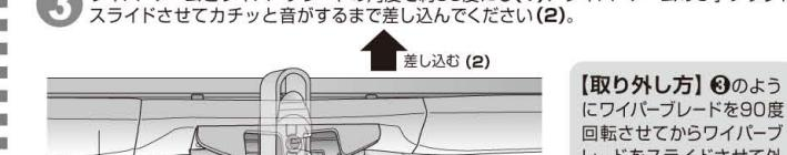
【取り外し方】①のようにワイパープレードを90度回転させてからワイパープレードをスライドさせて外してください。
